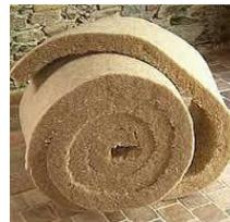
La laine est utilisée dans la construction comme isolant
